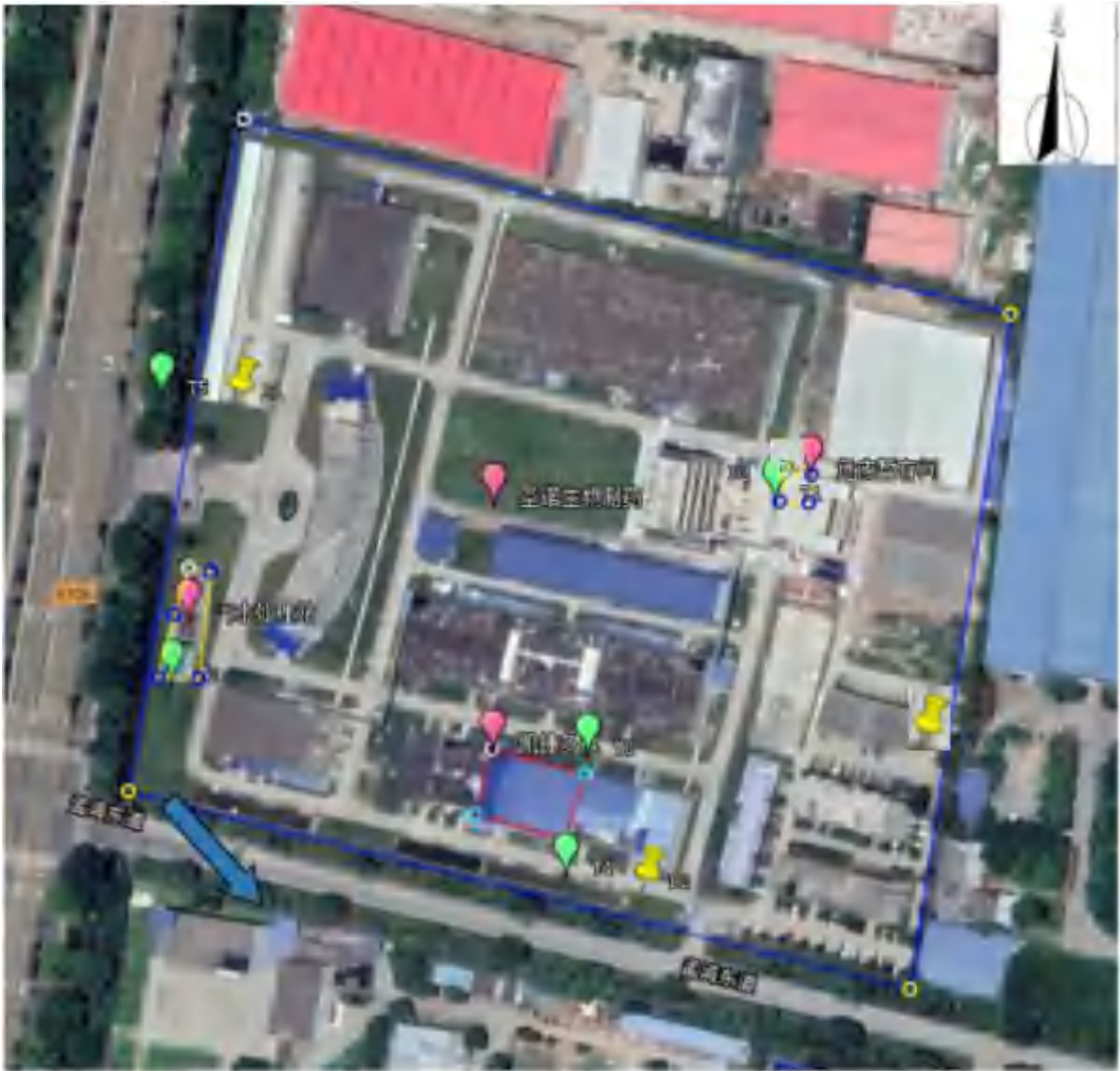
图例：📍表示土壤监测点位，📍表示地下水监测点位，➡表示地下水流向
